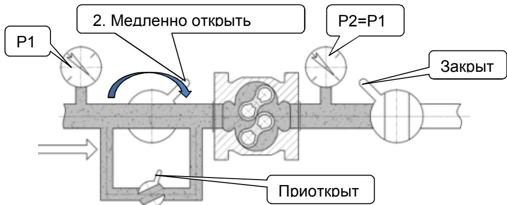
Рисунок 9 – Открытие запорного устройства до счетчика
