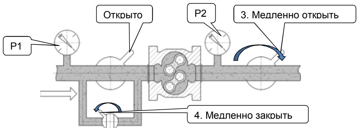
Рисунок 10 – Окончательный запуск
