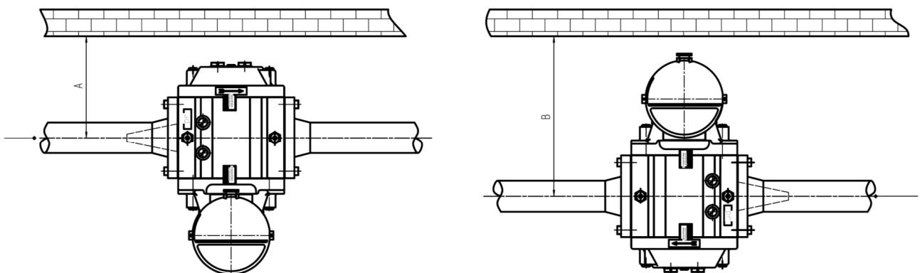
Рисунок 1 – Варианты монтажа счетчика
