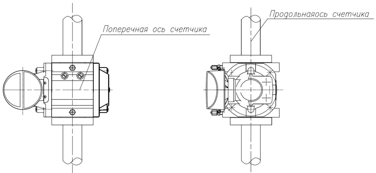
При вертикальном расположении счетчика RVG допустимое отклонение поперечной оси от горизонтальной плоскости не более  $\pm 1^\circ$  и продольной оси не более  $\pm 4^\circ$  от вертикали.
