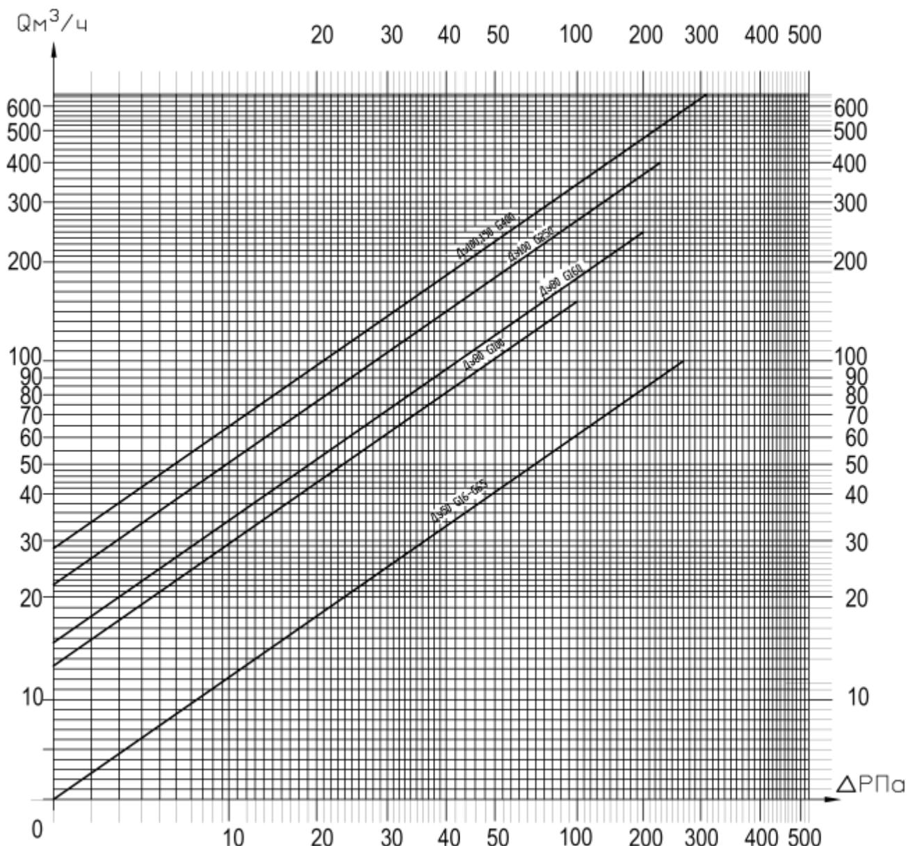
Графики приведены для воздуха с плотностью  $\rho = 1,29 \text{ кг}/\text{м}^3$  при давлении близком к атмосферному.
