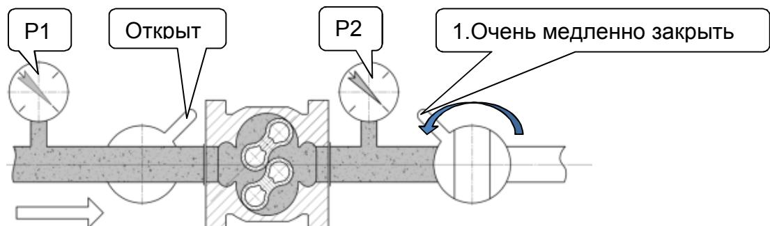
Рисунок 11 – Начало остановки счетчика
