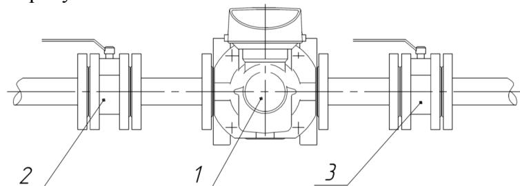
Рисунок 2 - Установка счетчика без перепускного канала
