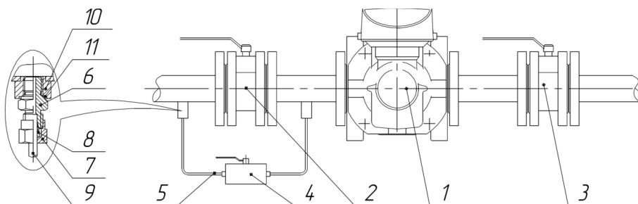
Рисунок 3 - Установка счетчика с перепускным каналом
