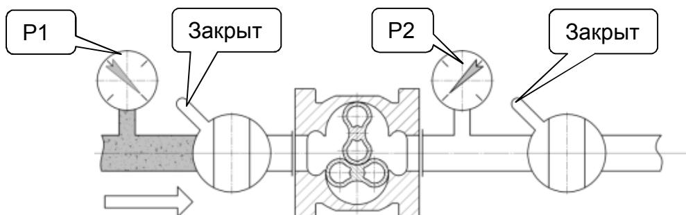
Рисунок 4- Положение запорных устройств до начала пуска
