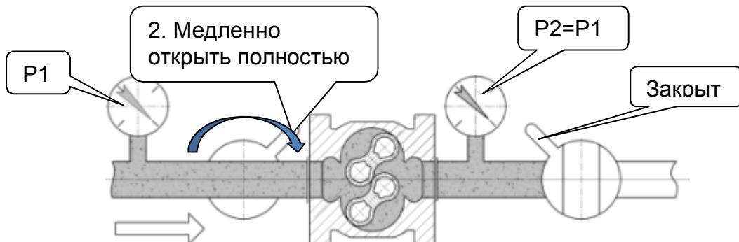
Рисунок 6 – Полное открытие запорного устройства до счетчика
