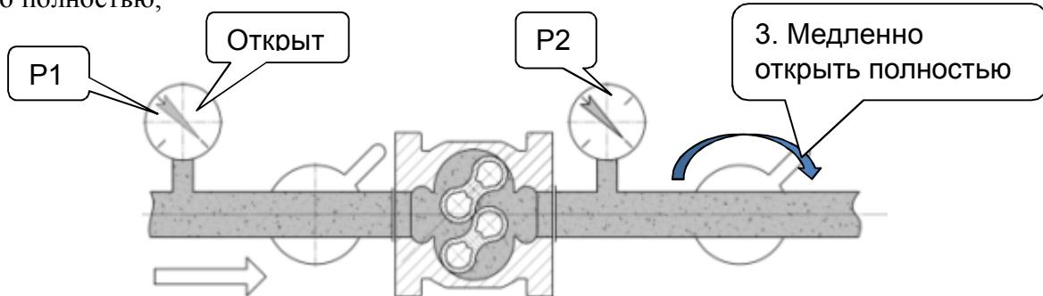
Рисунок 7 – Окончательный запуск
