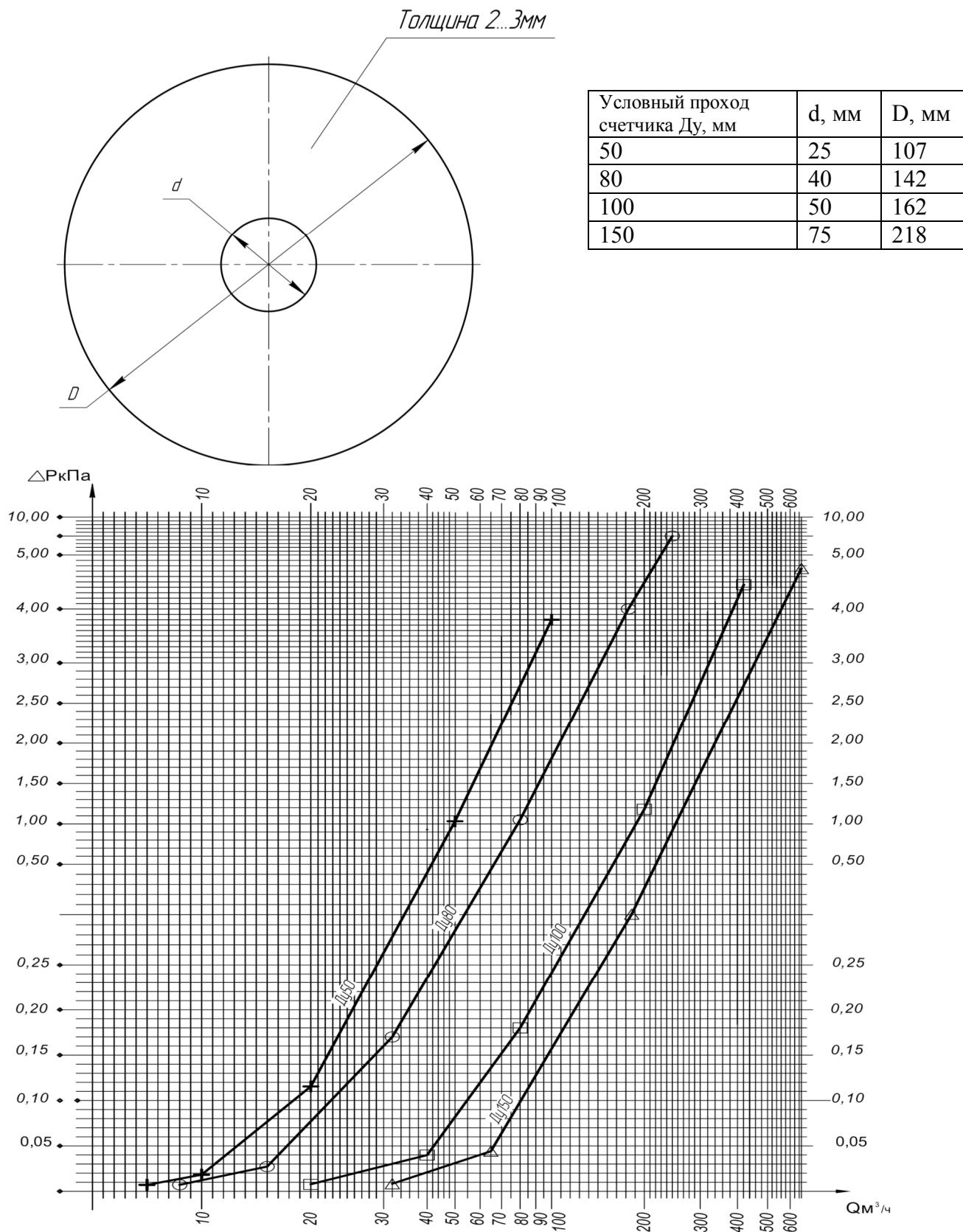
Зависимость перепада давления на предохранительной шайбе от расхода газа
