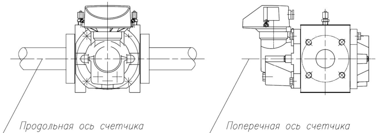
При горизонтальном расположении счетчика RVG допустимое отклонение осей от горизонтальной плоскости:
