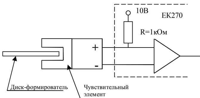
Рисунок 14 – Схема среднечастотного датчика импульсов R300
